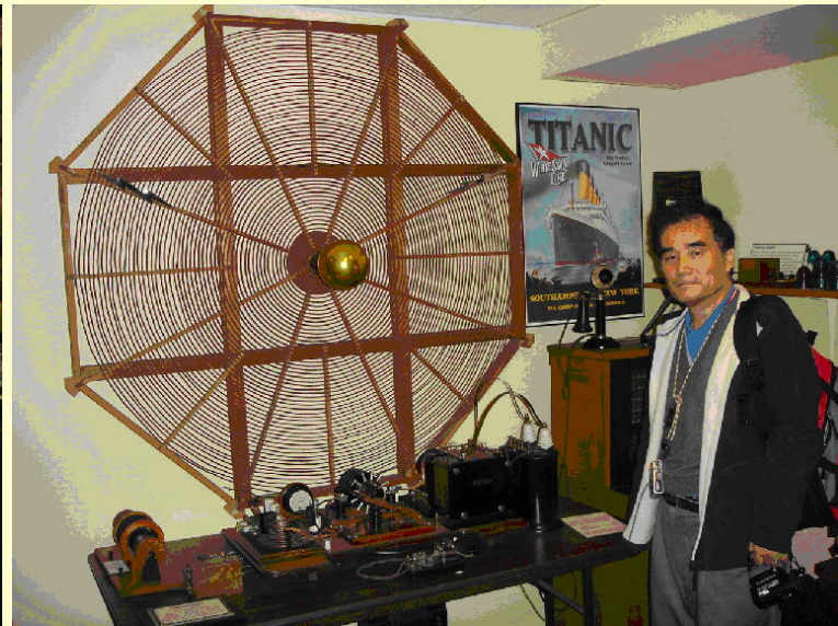
タイタニックが使用したような火花式送信機
