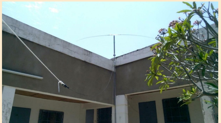
Fig. 14 (写真1) 軒先に上げたWonder-pole (奥)とBB6W (手前)
