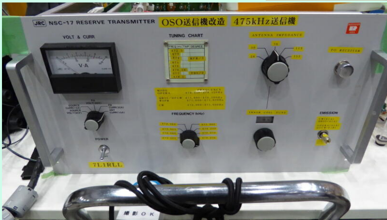
475kHz 送信機 (JRCの船舶用局補助送信機を改造)
